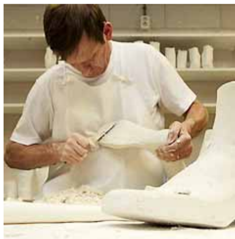
De gipsen mal wordt bewerkt.
